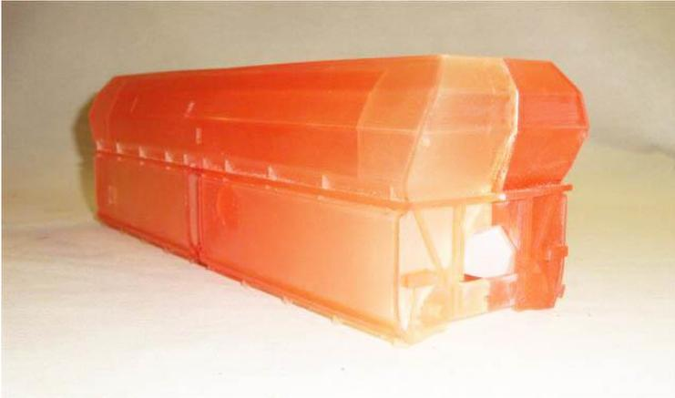
Das Gehäuse wird gezaubert, entfettet und mit einem Kunststoff primer lackiert.
